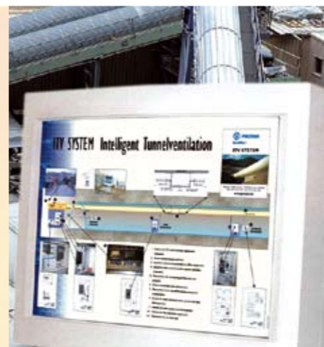
ITV overvåker og styrer kontinuerlig luftkvalitet og gassnivåer, og reduserer viftens energiforbruk.
